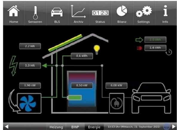
Photovoltaik erzeugt Energie. Die Energie reicht nicht aus, den Gesamtbedarf zu decken, deshalb wird die Leistung aus dem Stromnetz bezogen.
